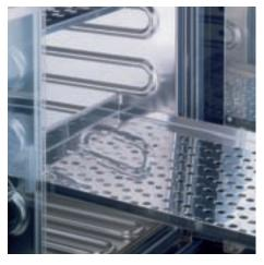
Особенность Memmert: камера 100% сделана из высококачественной нержавеющей стали мат. 1.4301 (ASTM 304) и с дополнительной электрополировкой для максимальной защиты от загрязнений.
